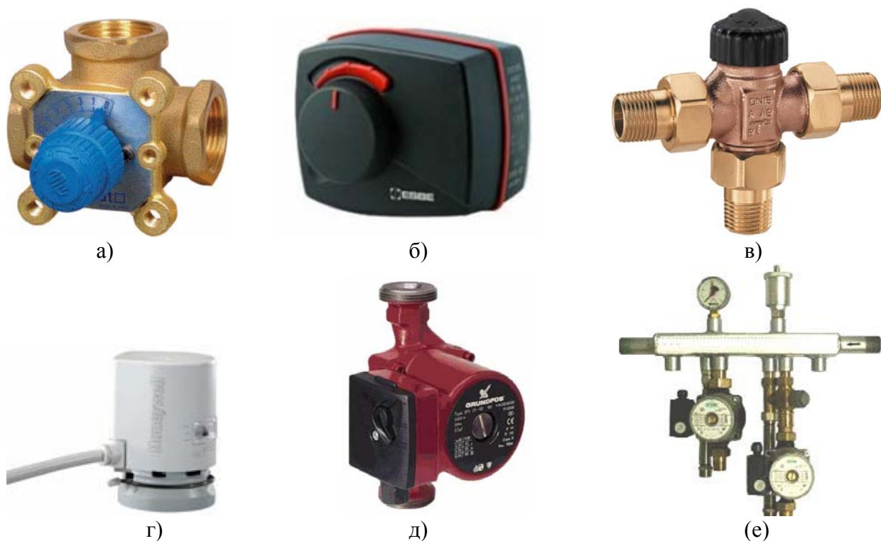
Рисунок 5 – примеры исполнительных устройств для реализации маломощных систем отопления: трехходовой смесительный клапан MUT Mechanics (Италия) (а); привод с трехточечным управлением для поворотного смесительного клапана ESBE (Швеция) (б); трехходовой штоковый разделительный клапан Heimeir (Германия) (в); термоэлектрический привод штокового клапана Honeywell (Германия); циркуляционный насос Grundfos (Дания) (д); комплект «Элемент-2» для подключения к котлу системы отопления двух потребительских групп общей мощностью до 30 кВт, ГидроЛОГО, с разрешения www.hydrumontage.ru , (е)
